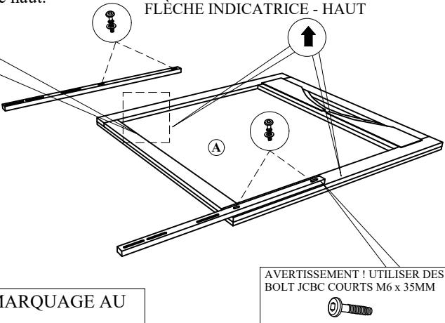
ETAPE 3: Placez le miroir (A) sur le dessus de la commode (C). Alignez et fixez le support du miroir (B) à l'arrière de la commode (C) en utilisant le boulon JCBC (2), la rondelle ressort (3) et la rondelle plate (4) PUIS SERRER ENTIÈREMENT TOUS LES BOULONS À L'ÉTAPE 2 ET 3 AVEC LA CLEF ALLEN (5).
