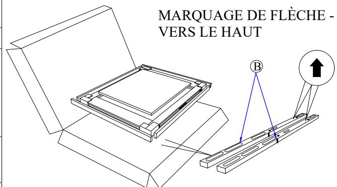
ETAPE 2: Alignez et fixez le support du miroir (B) à l'arrière du miroir (A) à l'aide d'un boulon JCBC (1), d'une rondelle de ressort (3) et d'une rondelle plate (4). ENSUITE, SERRER LES BOLTS AVEC UNE CLE ALLEN (5) NE PAS SERRER COMPLÈTEMENT À CET ÉTAPE. Remarque : Assurez-vous que le marquage en flèche du support du miroir (B) est dirigé vers le haut.
